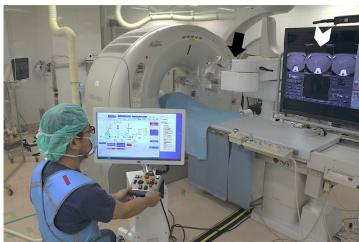
図2. ロボットを用いた手技。術者はCT画像 (矢頭) を見ながら、IVR-CT台に設置されたロボット本体 (矢印) をインタフェースを用いて遠隔操作している。
